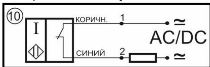
Схема соединения Нормально-замкнутый контакт
