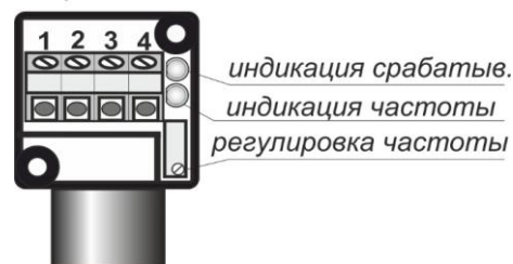
Цоколевка клеммной колодки
